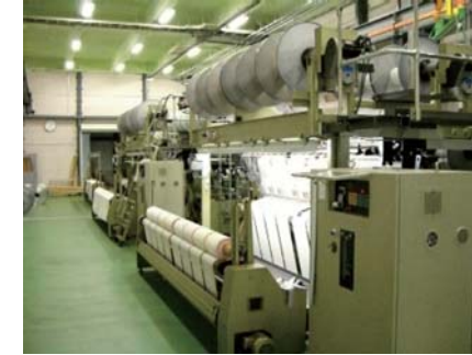
マイヤーラッセル機。多種多彩な生地を織み立てる
