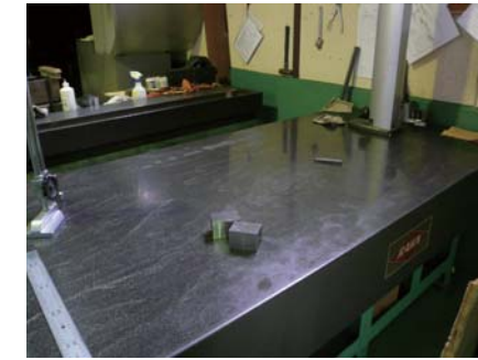
加工機械の横に検査台が置かれ、すぐに検査できる
