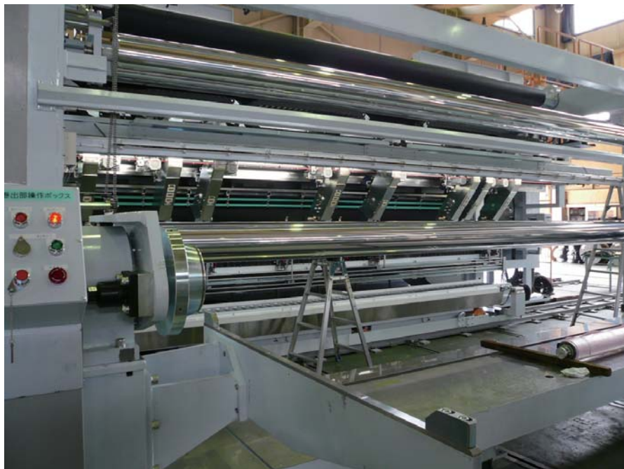
全長6mの大型スリッター
