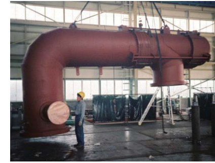
発電設備用のクロスオーバー管用伸縮管継手
