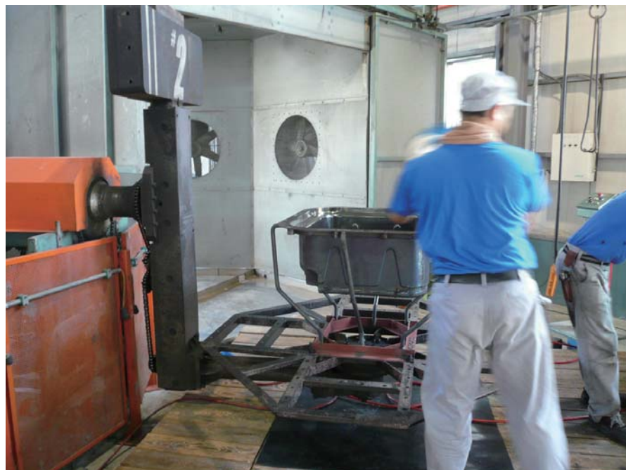
上下左右に回転し、メリーゴーラウンドのような製造機械
