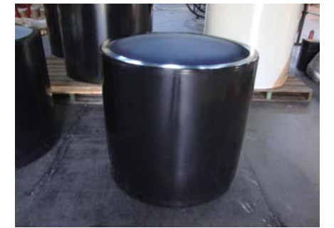
簡単に多層構造にできるのも回転成形製品の特徴
