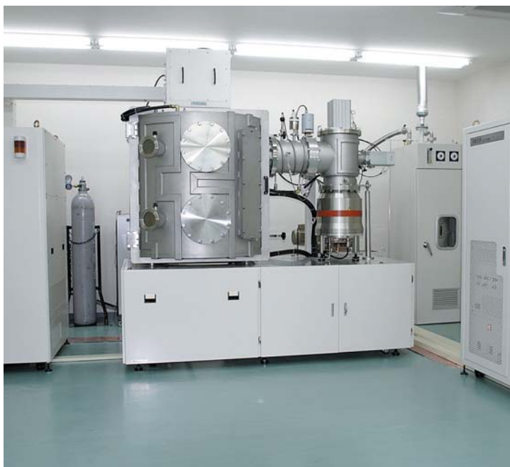
2005年に開発された、プラズマイオン注入装置の大型モデル。パルス状に高電圧をかける電源部分に、電機メーカーとしての同社の技術が大きく活かされている。
