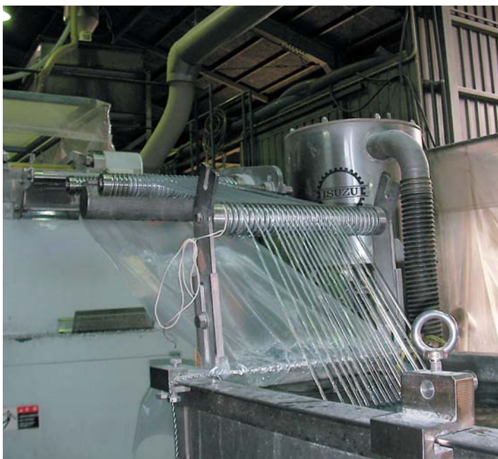
回収ペットボトルは、同社の製造設備を使って成形用素材へと加工。長い年月で蓄積された樹脂加工のノウハウが活かされている
