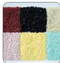
回収ペットボトルは、同社の製造設備を使って成形用素材へと加工。長い年月で蓄積された樹脂加工のノウハウが活かされている
