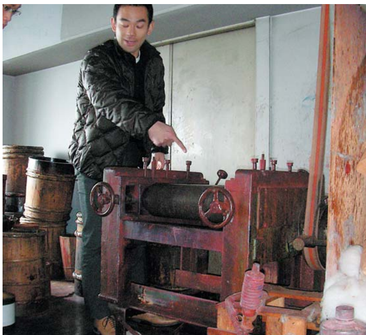
工場にて。中央の機械は顔料を練るためのものだが、MR漆は、この機械と似た構造の、ロールを用いた製法で製造される。ロールにより加熱せず脱水することがポイント。
