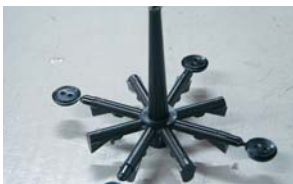
射出成形されたボタン。金型の中をプラスチックが通って、先端に至り、ボタンを形成する。
