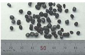
高熱伝導率プラスチックの素材。 これを溶かして金型に流し込み、 製品を成形していく
