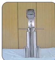
内容量 70ml タイプ（手前）と 1000ml タイプの凍結昇圧容器。コンパクトサイズの 70ml タイプは、家庭用冷凍庫でも使用可能。容器の中に鶏のササミを入れておけば、簡単にハムを作ることができる。
