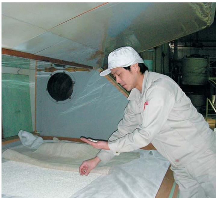
蒸し米に麹菌を種つけし、30℃に保った室（もろ）で約48時間培養する。熟練の技が必要な工程だが、同社では、センターとの研究開発で得た科学的な手法をふんだんに取り入れている
