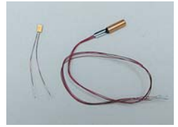
極低温下で磁場に感応しない温度計用測温抵抗体
