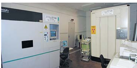
光造形装置（手前）と X 線 CT の設置室
