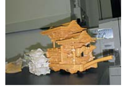
光造形による成形品(中央)と、その元となった立体形状。正確に形状が再現されている
