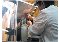
「エレクトロスピニング」直径50～800nmのナノファイバーの製造が可能。
