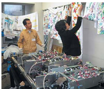
当センターが企業と共同開発した静電電子写真方式の捺染用試験機
