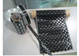
開繊技術を使った繊維のサンプル。 5～7ミクロンの糸が12,000本集まった束から作られている
