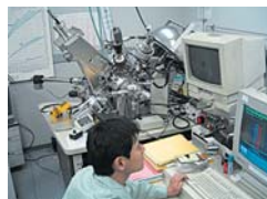
X線光電子分光分析装置。X線を試料に照射し、試料から放出される光電子を測定する装置で元素分析に用いられる。
