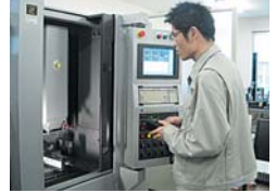
直径 0.5mm 以下の極小径工具を高速回転させて、硬脆性材料の精密加工を行う超高速回転三次元精密加工装置
