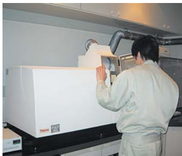
日本小型自動車振興会の補助事業により「ICP-質量分析システム」を導入。各種製品の環境対策、高性能化に関する支援が実現した。
