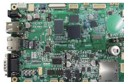
Linux OSを搭載した 小型マザーボード「AELAS」 160mm × 110mm
