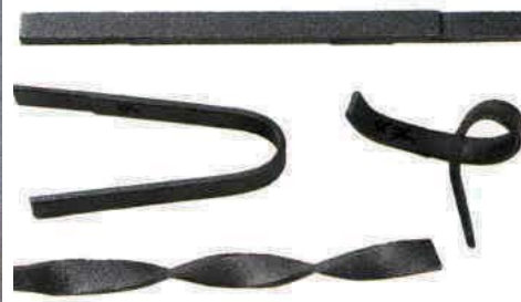
白心可鍛鑄鉄には曲げても割れない粘り強さがある
