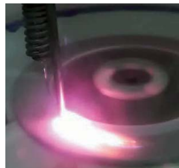
回転円盤を用いた放電電解の様子
