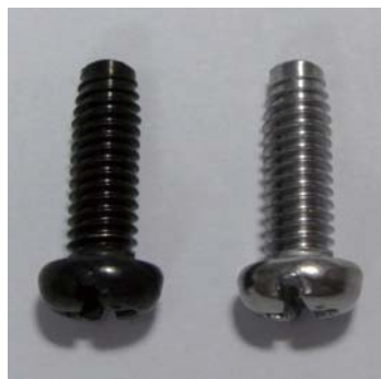
複雑形状基材への緻密質炭素膜の形成例
