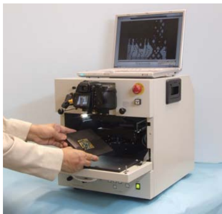
可搬型X線透視装置。1台で検体試料の外観像とX線透視像をみることができ、簡単に操作できるのが利点。
