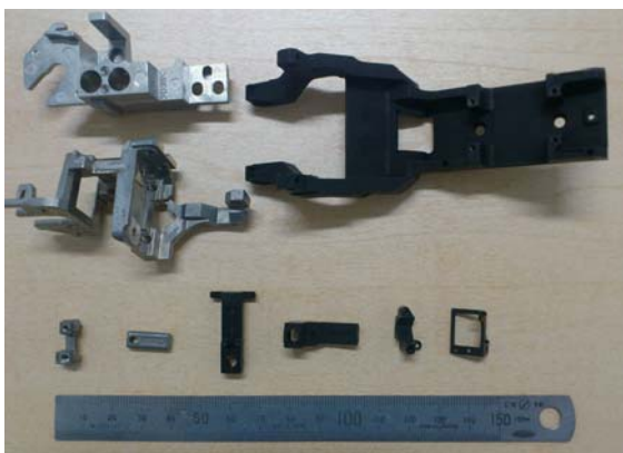
使用素材は、亜鉛、アルミニウムなどの非鉄金属とその合金。 10mm以下アルミダイカストの製品化を実現する。
