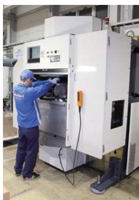
マルチワイヤーソーの外観と加工部、及び切断の様子。 同社の独自技術である「揺動機構」により、ワイヤーが素材を円弧状にスライス。
