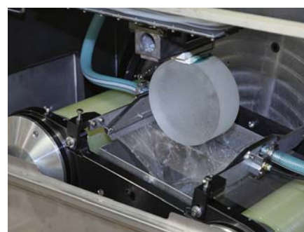
マルチワイヤーソーの外観と加工部、及び切断の様子。 同社の独自技術である「揺動機構」により、ワイヤーが素材を円弧状にスライス。
