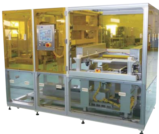
大気 Bend 方式のカバー・ガラス貼り合わせ装置
