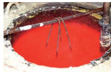
850℃のソルトバスに、品物をカゴに入れて加熱処理を行う。
