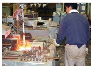
850℃のソルトバスに、品物をカゴに入れて加熱処理を行う。
