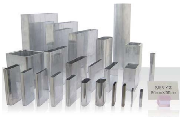
インパクト加工による成型例。1工程で成形できて、加工スピードも早いいため、作業時間の短縮が可能。
