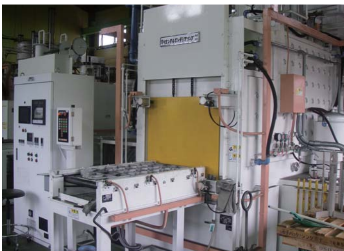
巨大なギアもFCD浸炭処理される。FCD浸炭処理により耐摩耗性、耐熱性能が飛躍的に向上。
