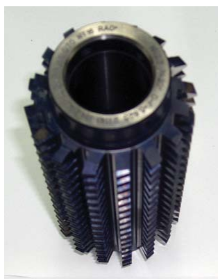
KHT 処理されたネジ切り用の転造ダイス（写真左）とギアの歯を削り出すホブ
