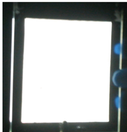
▲開発した発光材料の発光写真 50mm 角の大面积に亘る発光を実現
