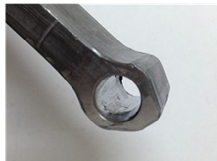
▲外形未拘束によるパンチ孔あけ
