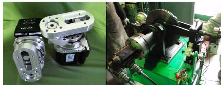
▲リンク式大型関節(左)とトルク試験(右)
