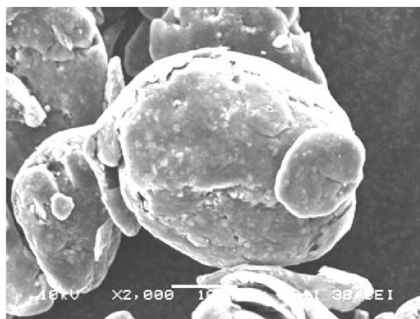
▲負極材 SCC 粒子の SEM 画像
