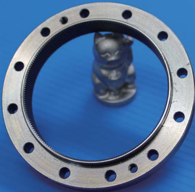
シナジー効果ハイブリッド低温表面処理技術 JAXA 宇宙用ステンレス鋼波動歯車の共同研究
