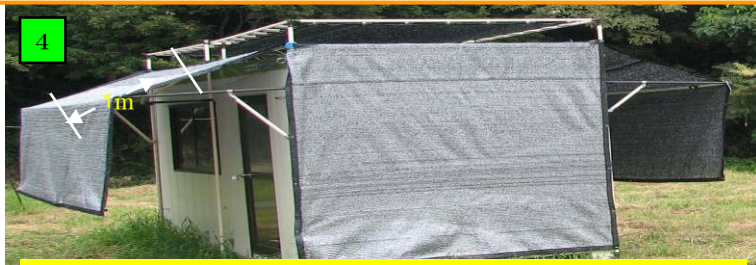
窓と戸のアルミ除去、前夜夕立、窓側壁面1m外に出す
