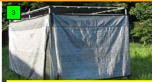
4面の壁面は遮熱ネットでカバー
