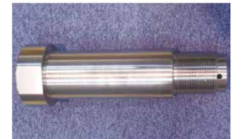
推進軸・中間軸・クランク軸の結合用固定ボルト
