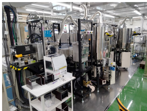
ペロブスカイト太陽電池の製造プラント
