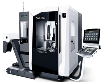
精密機器の部品を生み出す 自動制御加工機 (マシニングセンター)
