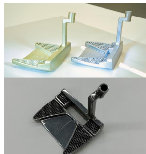
今回開発したゴルフパターヘッド （上）メタリック調電着処理
