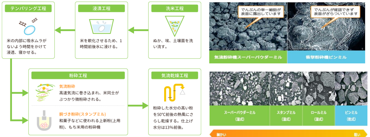
湿式と乾式、気流粉碎機と衝撃粉碎機におけるでんぶん損傷と粒度比較
