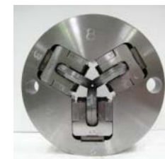
写真2 圧延ロール（左：2方向タイプ、中および右：3方向タイプ）
