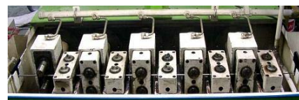
写真2 圧延ロール（左：2方向タイプ、中および右：3方向タイプ）
