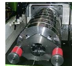
写真2 圧延ロール（左：2方向タイプ、中および右：3方向タイプ）
