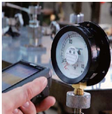
RFIDタグ圧力計による 設備保全管理システム
