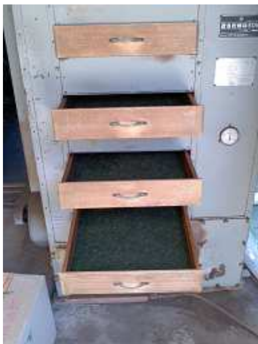
再火入れに使用する『温風乾燥機』
