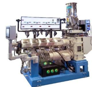
溶融樹脂の“見える化”を実現した『可視化押出機』。実験機として弊社R&D施設に常設しています。
