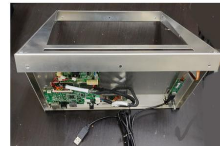
空中タッチディスプレイに必要なキーパーツを組み込んだモジュール
