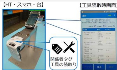
RFIDを利用した工具管理システム
