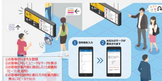
ビーコンを利用した可変式案内システム
