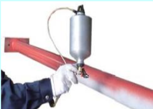
配管等の防さび対策
