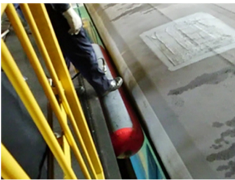
使用例：車両屋根と足場との隙間に使用
