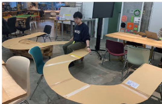
1) ダンボールで実寸サイズのベンチ座面を作成。適正サイズや利用方法を検証
