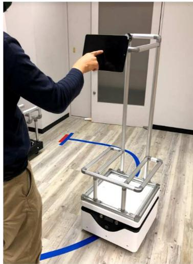
そして、現在開発中で、将来的には当社製品の核になるとみられるのが、積載物を自動で搬送する自律移動ロボット「KeiganAMR」である。
