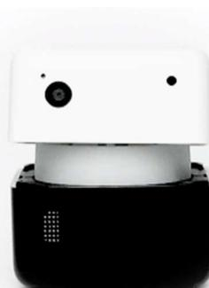
当社設立後、幅広い分野に対応できるサービスロボットの開発に着手。こうした中で、AIテクノロジーによる対人接客業務の自動化、省力化を目指し、顔認識カメラ、IoT リモコンを搭載したパーソナル・アシスタント・ロボットの「PLEN Cube」を開発し、2018年12月にリリースしている。
